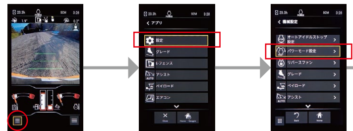
ホーム画面 アプリメニュー ボタンをタッチ 「設定」をタッチ 「パワーモード設定」 をタッチ
