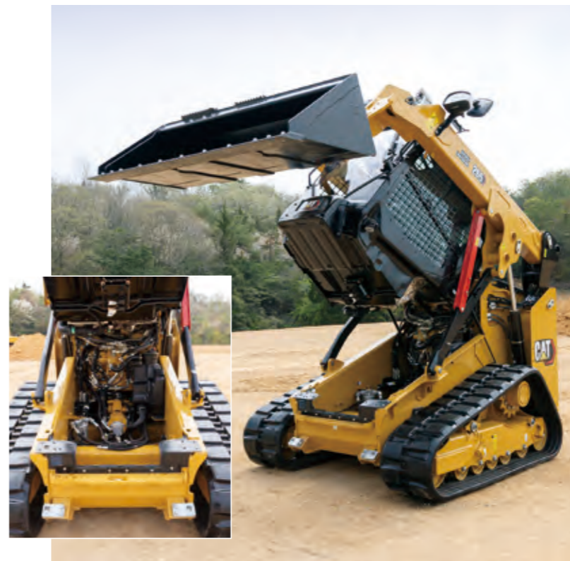
チルトアップされた運転席、各コンポーネントの点検・整備が容易
