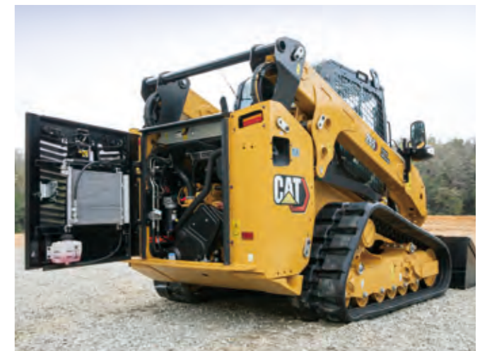
後方サービスドアが大きく横開きし、グランドメンテナンスが容易
