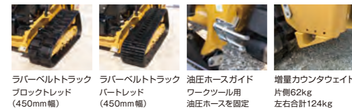
ラバーベルトトラック ブロックレッド (450mm幅) ラバーベルトトラック パートレッド (450mm幅) 油圧ホースガイド ワークツール用 油圧ホースを固定 増量カウンタウエイト 片側62kg 左右合計124kg
