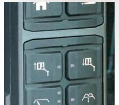
チルト角度の調整は、キャブ内の右コンソールにあるボタンにて容易に操作できます
