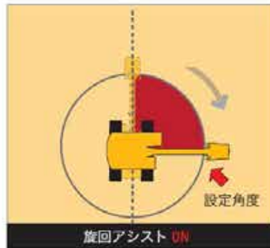
設定角度で自動停止 レバーを中立に戻せば再び旋回可能
