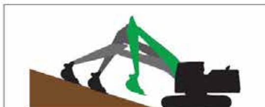
掘り過ぎ防止コントロール
