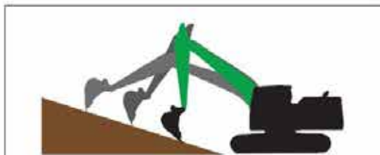
法面整形コントロール
