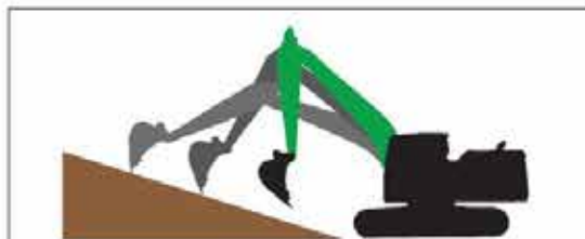
掘り過ぎ防止コントロール
