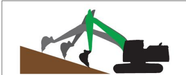
法面整形コントロール
