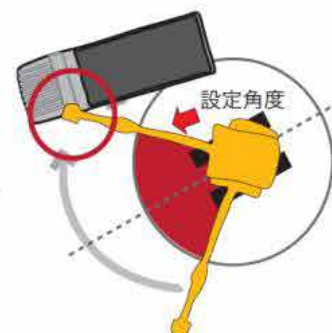
作業装置を伸ばした状態では 巡回角度を制限しても障害物に接触
