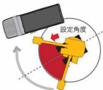
作業装置を巻き込んだ状態で 巡回角度を設定
