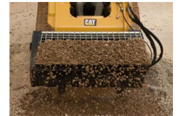
ミキシングバケット 内蔵のオーガで各種材料を混合したい肥のかく拌にも
