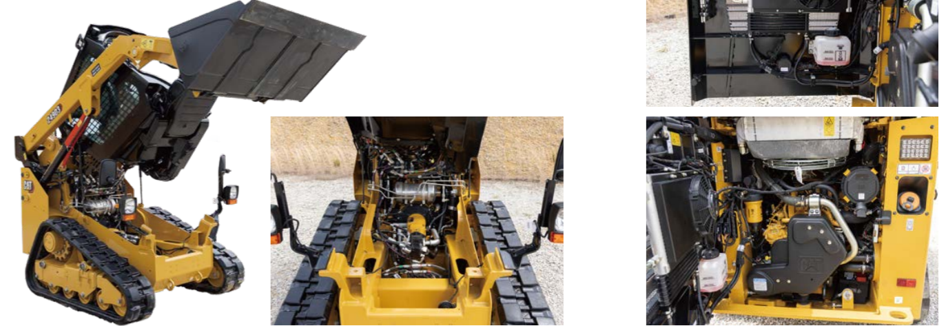
チルトアップされた運転席、各コンポーネントの点検・整備が容易
