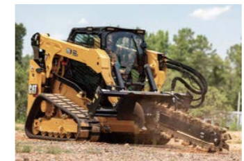
トレンチャ 各種ケーブル、パイプや暗渠埋設用の狭い直線状の溝を掘削
