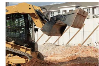
マルチパースバケット バケット前部が開閉 掘削、押土、掴み、敷均し、整地など
