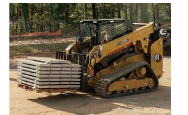
パレットフォーク 建設現場、工場などにおける資材、パレットに載った取扱い材料の運搬
