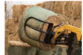
ボールグラブ 牧草などのボールを掴んで運搬、積み込み
