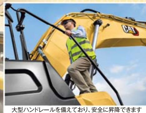
大型ハンドレールを備えており、安全に昇降できます
