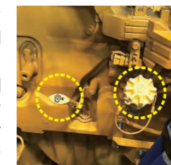
エンジンオイル投入口(右)とエンジンオイルレベルチェック用のディップスティック(左)
