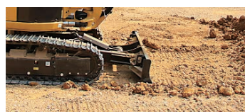
ブレードの自重を利用して整地作業を容易に行うことができます。
