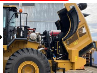
自動でエンジンフードが 開くのでグラウンドレベル での点検が可能
